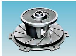
Impulsor con cortador, semi-abierto con dos venas centradas y dos insertos de carburo de tungsteno, las cuales rotan en un plato de succión con dientes así permitiendo cortar cualquier material que pase por la cavidad de succión.
