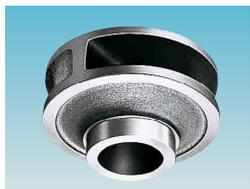
Impulsor cerrado (de canal) viene con una o dos venas, tiene un canal bastante amplio desde la entrada a la salida, el cual permite el paso de solidos con un mínimo bloqueo.
