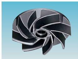
Impulsor de Vórtice, la rotación de este impulsor produce un remolino centrífugo entre el impulsor y la voluta, así creando un espacio entre el mismo y poder bombear solidos y materiales fibrosos, sin tener obstrucciones.
