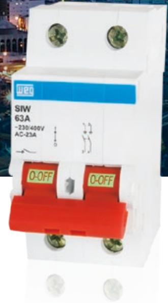
Los interruptores seccionadores SIW poseen las mismas estructuras de los minidisjuntores MDW en las versiones bipolar, tripolar y tetrapolar, no obstante, son desprovistos de los disparadores térmicos y magnéticos. Su función es seccionar circuitos eléctricos con corrientes hasta 100 A, conforme la norma IEC 60947-3. Los seccionadores SIW cuentan con bloques de contacto auxiliar y traba candado, suministrados como accesorios.
